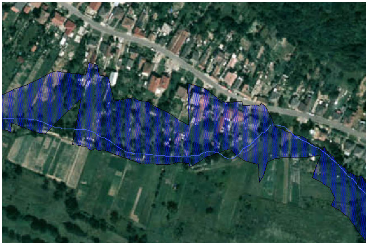
Obr. 5.: Namodelované inundácie 100-ročnej vody v centrálnej časti intravilánu Borinky.
