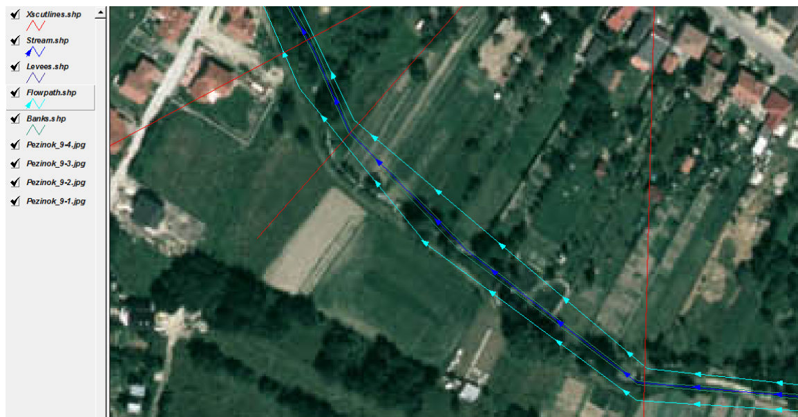
Obr. 1. Vyznačené vstupné data ako sú vodný tok, brehy, prúdnice a priečne profily
