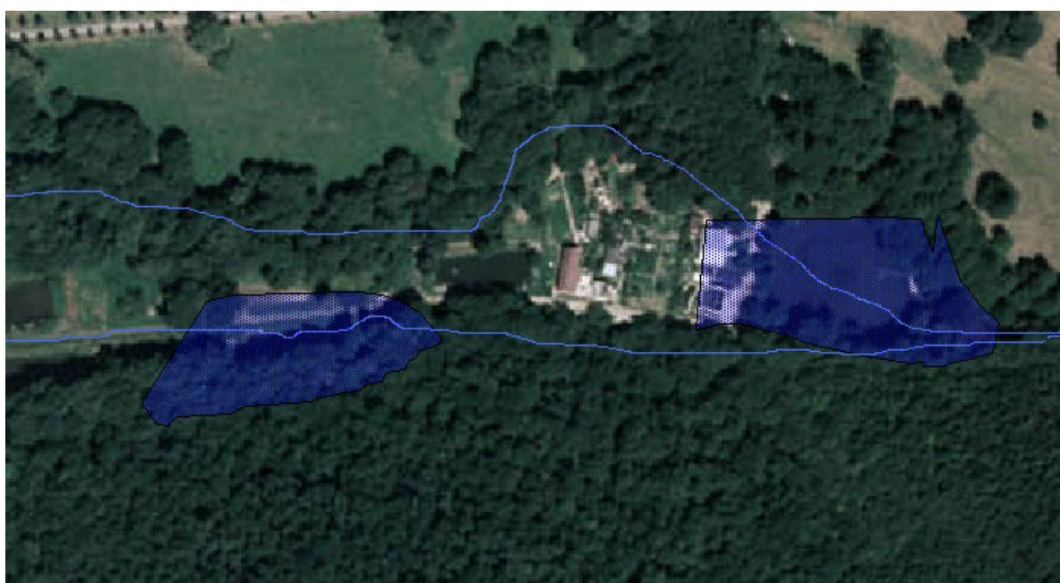
Obr. 6. : Namodelované inundácie 100-ročnej vody vo východnej časti intravilánu Stupavy (lokalita stupavských rybníkov)
