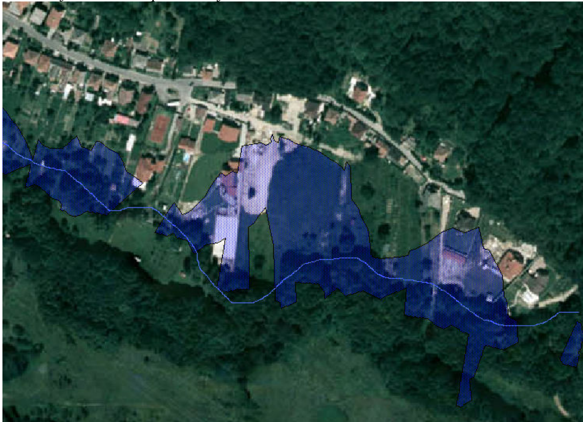
Obr. 4.: Namodelované inundácie 100-ročnej vody vo východnej (hornej) časti intravilánu Borinky.
