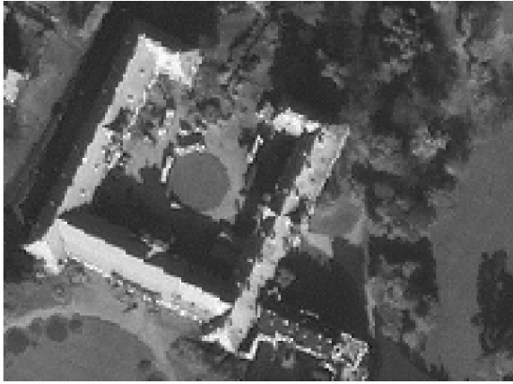
Obr. 4. a 5. Výsledek segmentace pro maximální směrodatnou odchylku 20, minimální velikost segmentu 107 pixelů a bez morfologické transformace (data IKONOS PAN 1 m)
