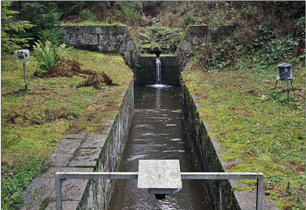
Obr. 6: Závěrový profil povodí Červíku a jeho vybavení měřícími přístroji (foto B. Šír)
