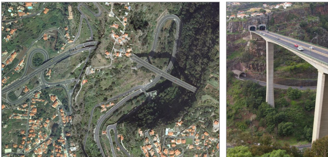
Obr. 1. Příklad mimoúrovňové křižovatky s tunelem ve strmém madeirském terénu. Oblast v severovýchodní části Funchalu. Orotofoto od Instituto Geográfico Português, fotografie z Panoramia.
