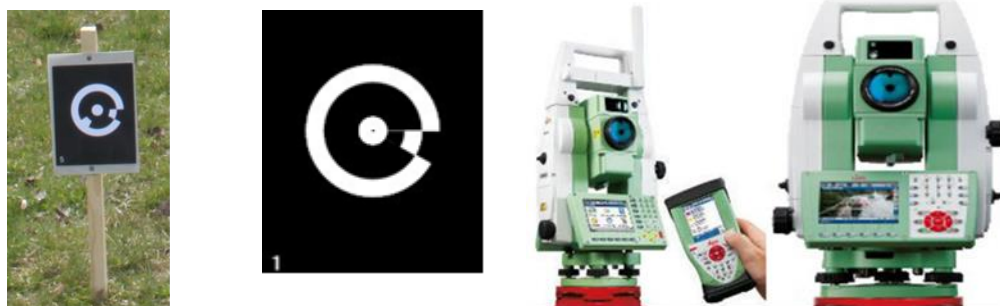
Obr. 1. Kódový terčik a elektronický tachymeter TS15.
