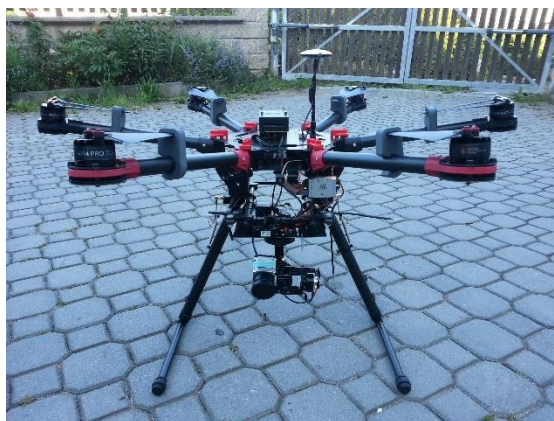
Obr. 1 Dron s termální kamerou Optris PI 450
