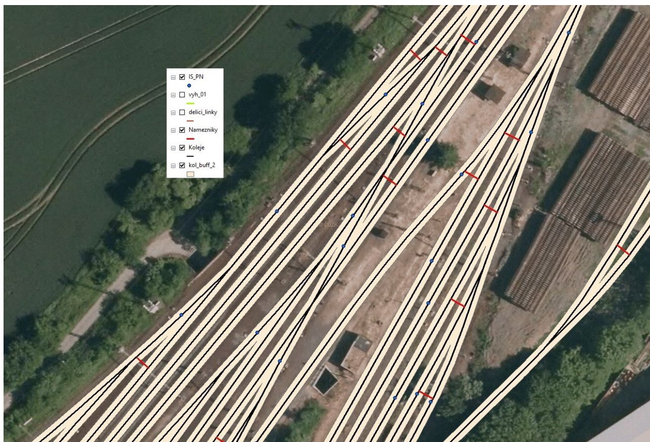
Obr. 5 Kontrola průjezdních profilů vozidel pomocí námezníků (garantovaná přesnost)
