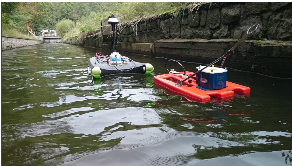
Obr. 3. ADCP přístroje SonTek RiverSurveyor M9 a Teledyne RDI StreamPro během měření v Hanušovickém náhonu.
