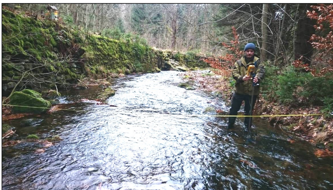
Obr. 2. Měření Q na Šumném potoce u Vodárny pomocí ADV FlowTracker2 (foto Ivo Winkler).
