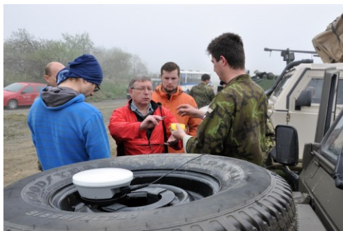
Obr. 5 Příklad umístění externí antény přijímače GPS Trimble na vozidle LR 110 (foto P. Zerzán)
