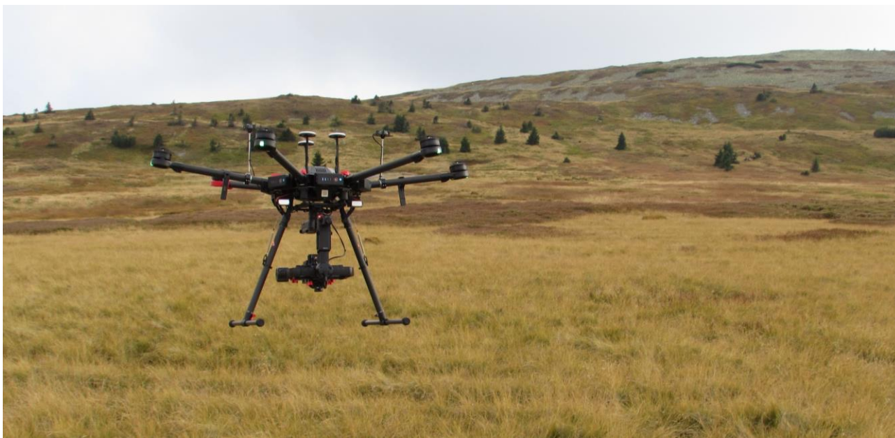
Obr. 1. DJI Matrice 600 Pro s hyperspektrální kamerou Headwall Nano-Hyperspec® před přistáním na Bílé louce v Krkonoších
