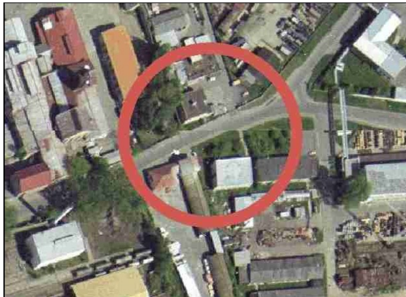
Obr. 5 - Geometrická nepresnosť na hranách mapových listov
