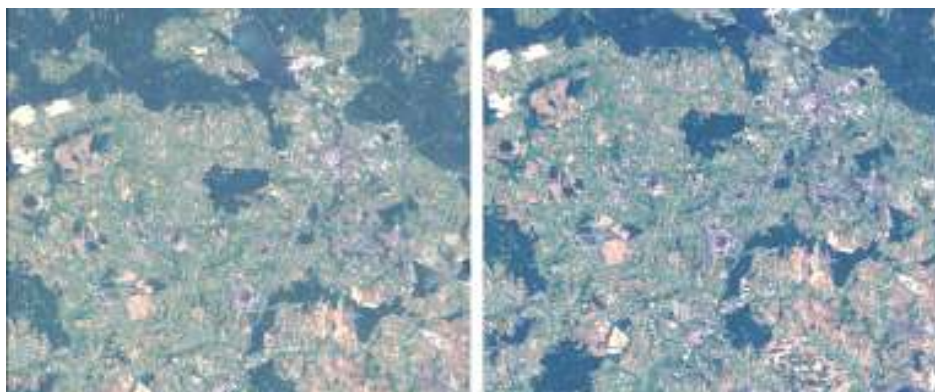
Obrázek 5 - srovnání výřezu původního snímku v DN (vlevo) a snímku převedeného do hodnot odrazivosti (vpravo)
