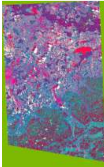
Obrázek 8 - PCA snímek snímače LANDSAT 7 ETM+ (RGB kompozice PC3, PC2, PC1)
