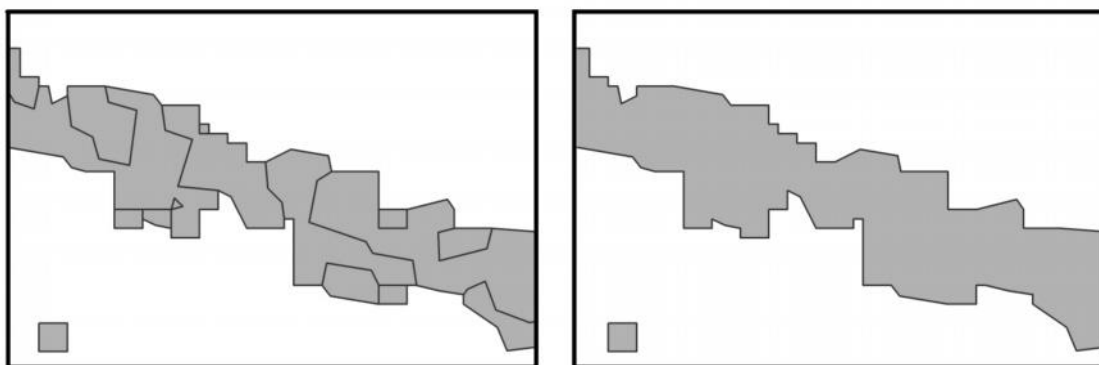
Obr. 12: Ukázka spojení stínů liniové vegetace - oddělené stíny vzniklé klasifikací a odečtením (vlevo) a následně spojené stíny (vpravo)
