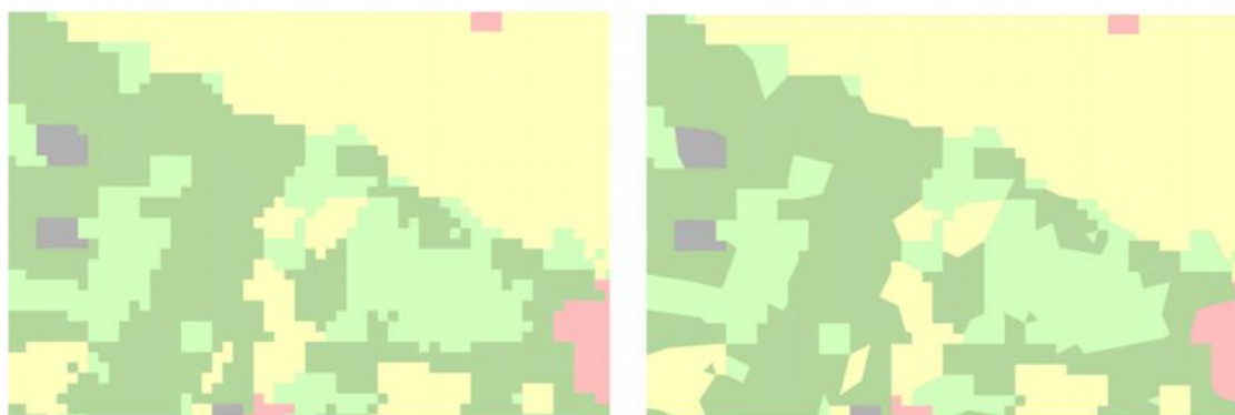
Obr. 10: Vliv změny parametru na tvar výsledných polygonů při převodu rastru na vektorovou vrstvu - funkce Simplify Polygons vypnutá (vlevo) a zapnutá (vpravo)
