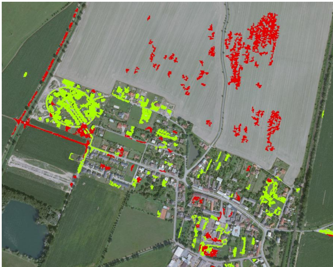
Obr. 20: Orientační vizualizace chybně klasifikovaných ploch (červené polygony) a ploch korektních (zelené polygony) (Zdroj ortofotosnímků: ČÚZK a Geodis)
