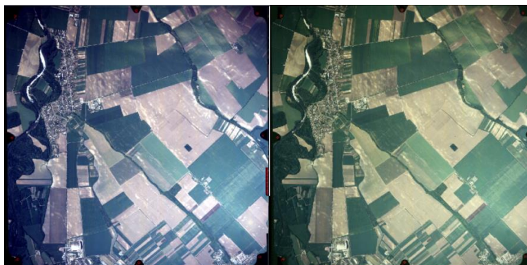
Obr. 4 – úprava obrazu pomocou nástroja Equalize Full v prostredí IRAS C
