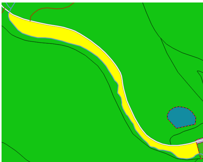
Obr. 8: Příklad nového sektoru ohraničeného bariérami ze všech stran. (Žlutá barva označuje vybraný prvek pro lepší přehlednost.)
