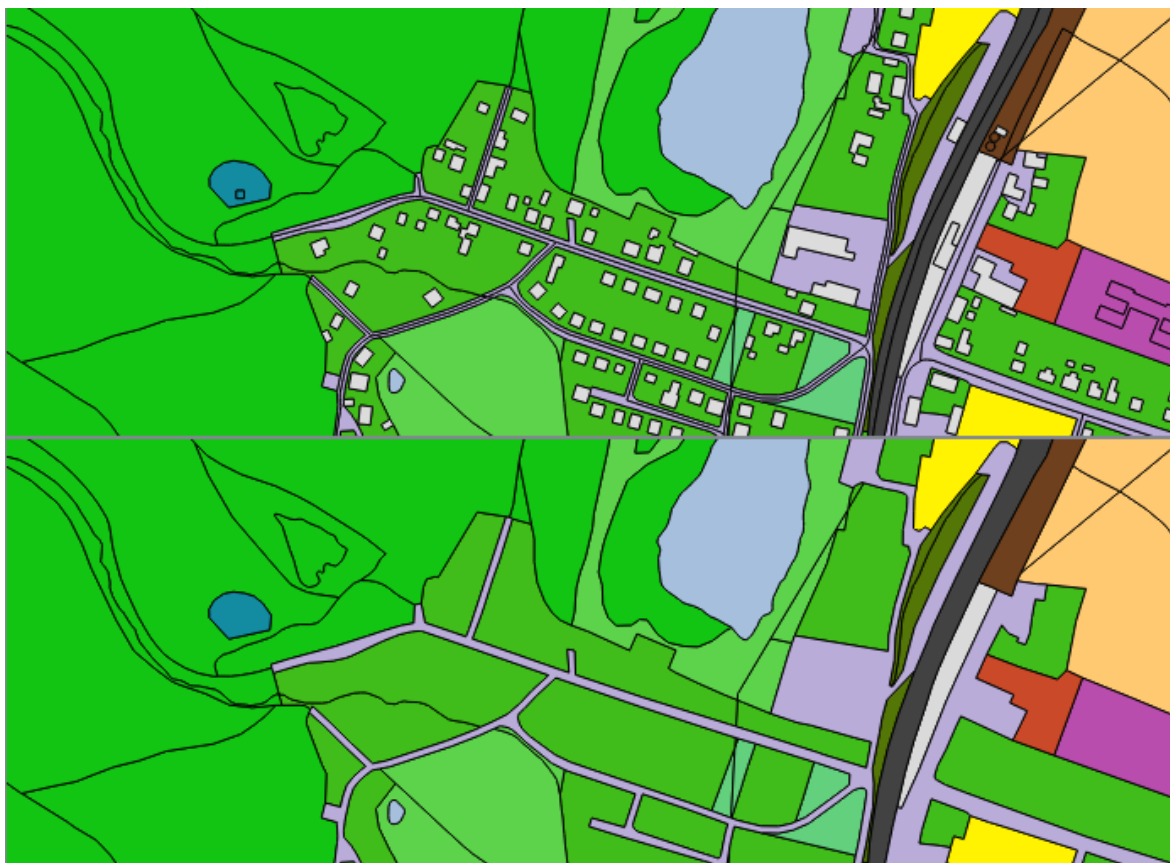
Obr. 13: Příklad eliminace přebytečných polygonů ve zkoumané oblasti. Nahoře – původní data, dole – data po eliminaci.
