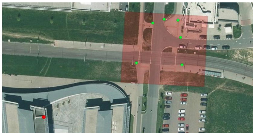
Obr. 4. Poloha kamery (červená tečka), oblast snímání (červená oblast) a transformační body (zelené tečky).
